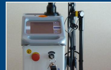
Primo laser storico in campo ORL, genera una luce coerente, monocromatica, invisibile con lunghezza di onda di 10600 nm. Il raggio è accoppiato ad un raggio visibile e una delle caratteristiche particolari è che i fotoni emessi hanno una alta affinità con le molecole di acqua e quindi sono fortemente assorbiti. Il laser in uso è fornito dalla azienda **El.En. Group** ([www.elengroup.com](http://www.elengroup.com)) di Firenze.
